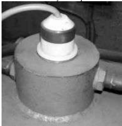
Рис. 3.42. Токоввод с автономным охлаждением
