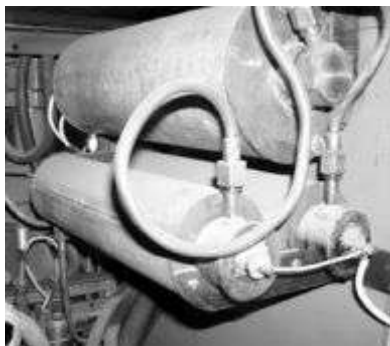
Рис. 3.45. Система очистки газовой среды
