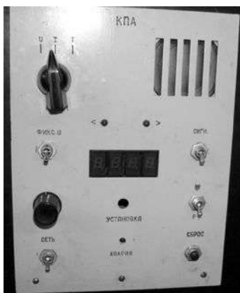
Рис. 3.25. Лицевая панель контроллера управления АТР
