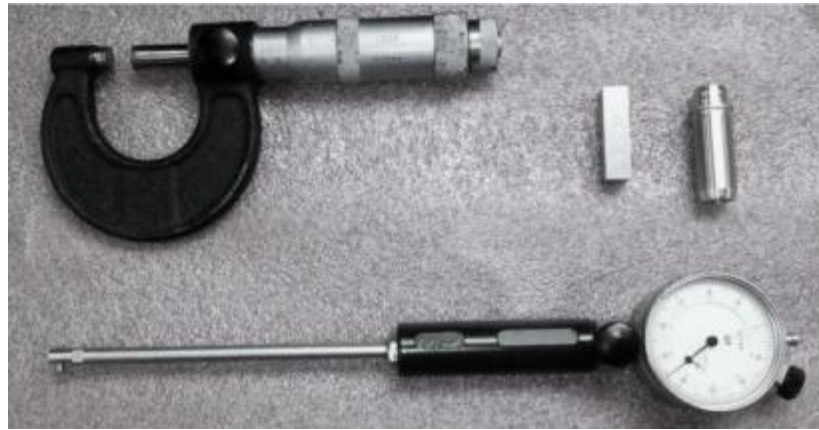
Рисунок 4.22 – Інструмент для вимірювання втулок клапанів.
