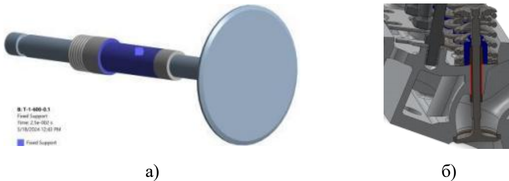
Рисунок 4.5 – Прикладання в'язей типу Fixed Support до напрямної клапана: а) обрані поверхні; б) перетин головки блоку з позначенням поверхонь кріплення напрямної (червоні лінії)
