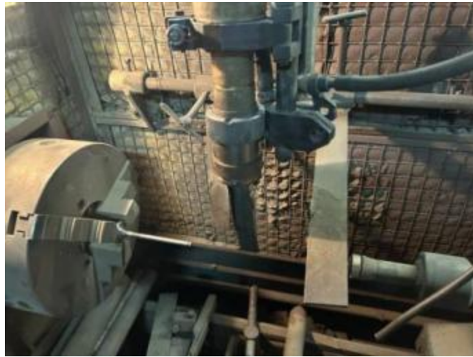
Рисунок 5.2 – Встановлення клапана для плазмово-дугового нанесення покриттів
