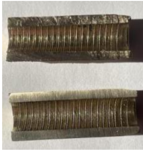
Рисунок 4.25 – Спиральні маслоутримувальні канавки напрямної втулки клапана
