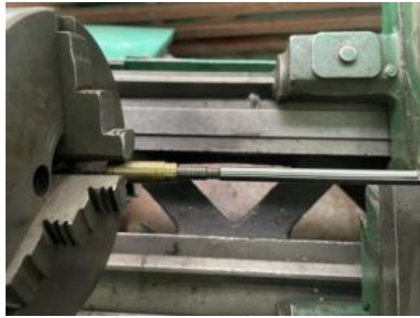
Рисунок 4.25 – Обробка маслоутримувального профілю напрямної втулки клапана
