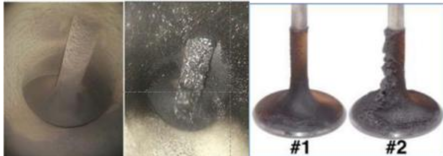
Рисунок 1.9. Відкладення на впускних клапанах
