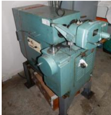
Рисунок 2.4 – Машина тертя СМЦ-2
