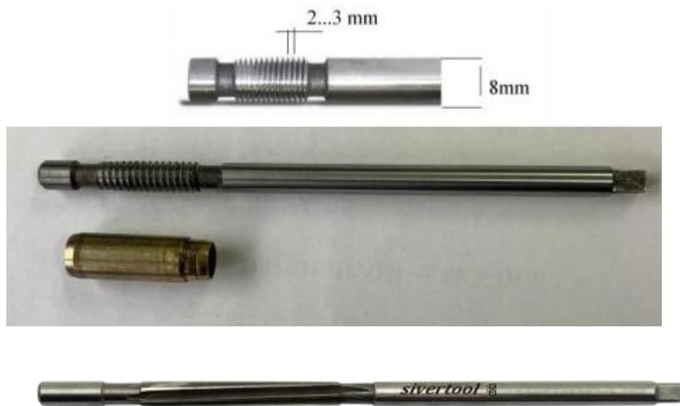
Рисунок 4.23 – Спеціальний інструмент для відновлення втулок клапанів.
