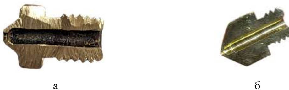
Рисунок Г.3 – Сопло в розрізі: a – з циліндричним та конічним каналом; б – з додатковим циліндричним каналом
