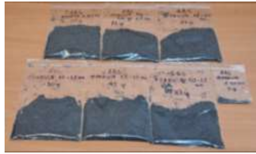
Рис.4.9 – Розподілені по фракціях подрібнені частки після зважування
