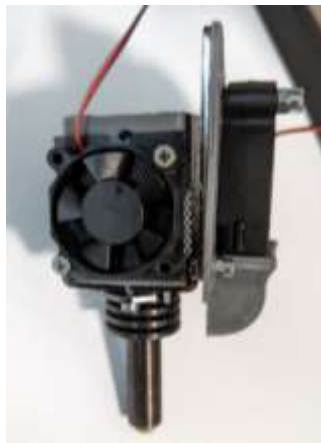
Рисунок 3.23 – Загальний вигляд екструдера зі встановленим додатковим вентилятором
