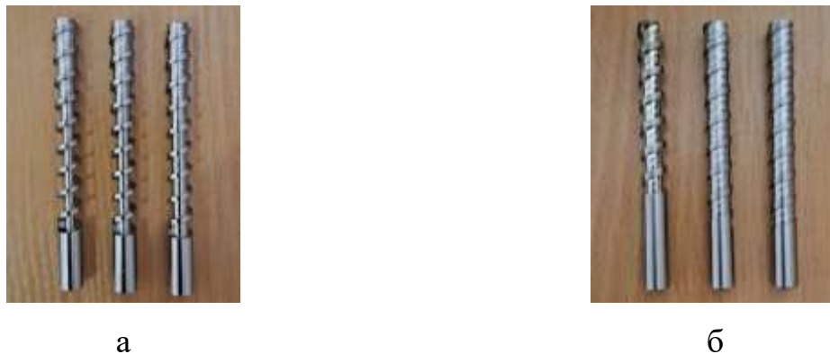
Рисунок 3.14 – Шнеки для екструдера: а – з постійним кроком та змінною глибиною гвинтового каналу; б – з постійним кроком та постійною глибиною гвинтового каналу
