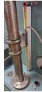
Рисунок 5.4 – Оптичний лінійний енкодер ASD
