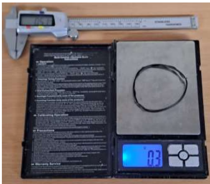
Рисунок М1 – Мононітка, надрукована з подрібнених часток ABS пластику на 3D-принтері з шнековим екструдером
