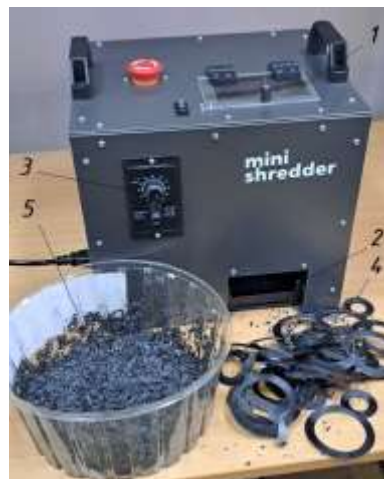
Рисунок 4.1 – Міні шредер для подрібнення полімерних відходів:
