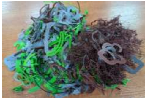
Рисунок 1.2 - Відходи пластику ABS, що утворюються під час 3D-друку [10]
