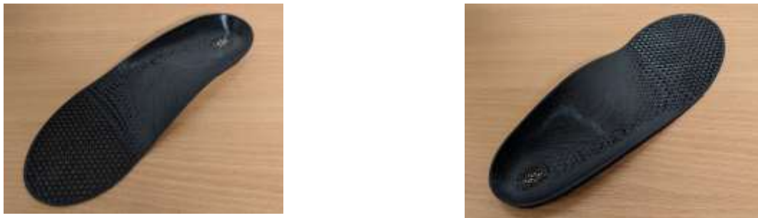
Рисунок 5.28 – Виріб «взуттєва ортопедична устілка», надрукований із подрібнених відходів TPU на обладнанні з шнековим екструдером
