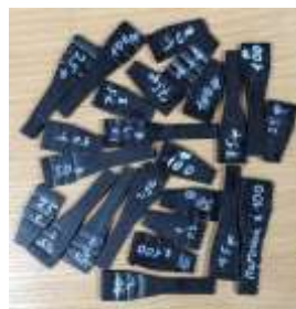
Рисунок 5.17 – Зразки ABS та TPU пластиків після статичного випробування на розтяг виготовлені з філаменту та подрібнених часток полімеру: а–ABS; б–TPU
