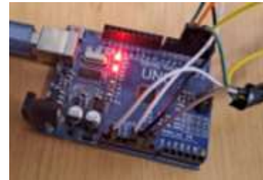
Рисунок 5.6 – Мікроконтролер Arduino Uno
