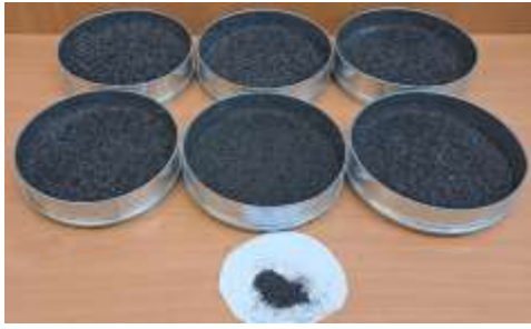
Рисунок 4.8 – Розподілені по фракціях подрібнені частки після просіювання
