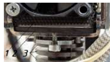
Рисунок 3.24 – Загальний вигляд екструдера зі встановленою термоізолюючою прокладкою:
