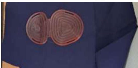
Рисунок 5.26 – Технічний текстильний матеріал з надрукованим об'ємним полімерним наколінником, виготовленим з гранул пластику TPU
