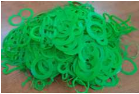
Рисунок 1.2 - Відходи пластику ABS, що утворюються під час 3D-друку [10]
