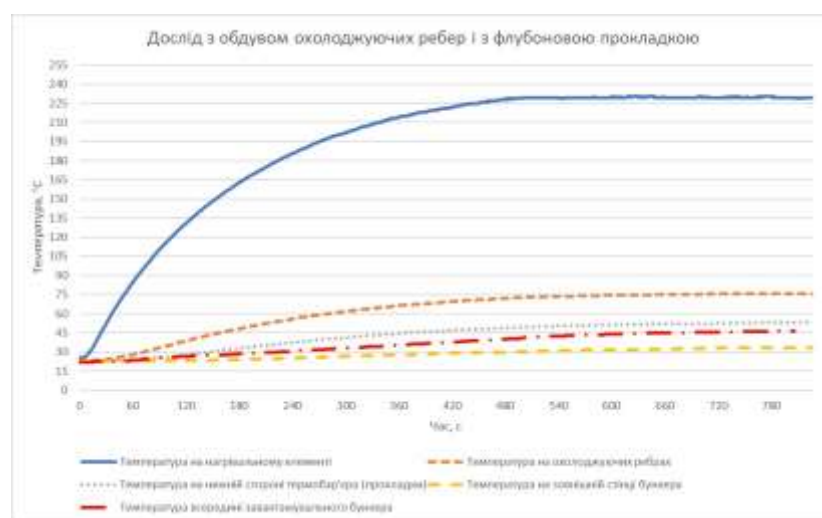
Рисунок 3.36 – Графіки зміни температури від часу в різних місцях шнекового екструдера з обдувом охолоджуючих ребер та обдувом полімеру в завантажувальному бункері і наявністю термобар'єру (флуоронової прокладки)
