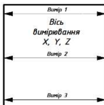
Рисунок П.8 - Схема вимірювання розмірів тестового зразка у вигляді куба
