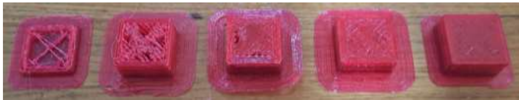
Рисунок 3.42 – Дефекти 3D-друку тестового кубика
