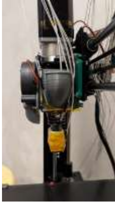
Рисунок 3.31 – Шнековий екструдер з під'єднаними терморезисторами
