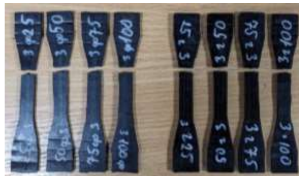
Рисунок 5.16 – Зразки ABS після статичного випробування на розтяг виготовлені з: а – філаменту; б – подрібнених полімерних відходів
