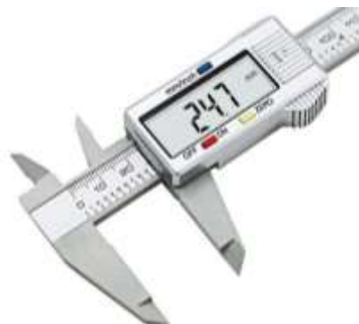
Рисунок П.1 – Загальний вигляд цифрового електронного штангенциркуля
