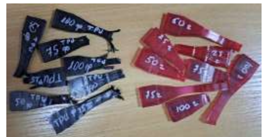
Рисунок 5.17 – Зразки ABS та TPU пластиків після статичного випробування на розтяг виготовлені з філаменту та подрібнених часток полімеру: а–ABS; б–TPU
