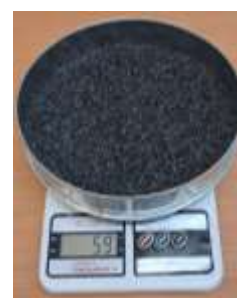
Рисунок 4.7 – Визначення маси фракції матеріалу на ситі
