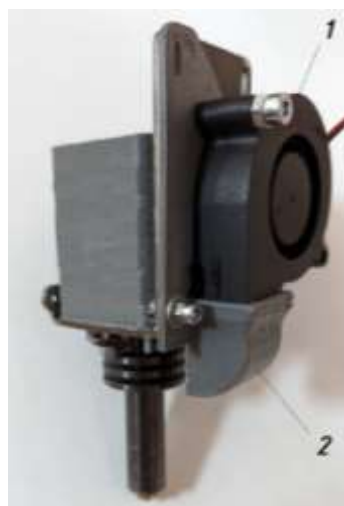
Рисунок 3.19 – Екструдер з повітряним охолодженням за допомогою вентилятора: 1 – турбінний вентилятор; 2 – направляюче сопло
