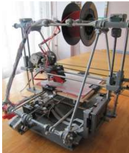
Рисунок 3.2 – Базова модель 3D-принтера з FDM-технологією друку
