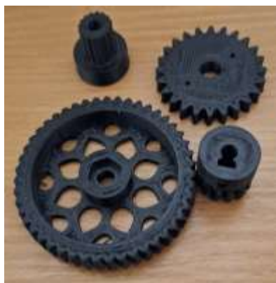
Рисунок 5.31 – Шестерні (відходи ABS пластику)
