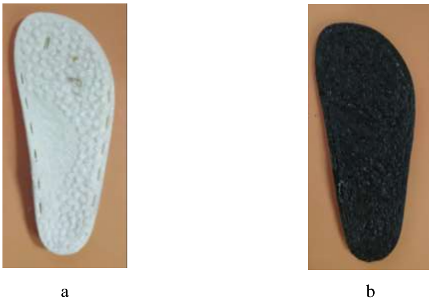
Рисунок 5.30 – Підшва взуття виготовлена методом 3D-друку з пластику TPU: а – філамент; б – подрібнені відходи
