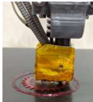
Рисунок 3.30 – Нагрівальний блок з тепловою ізоляцією
