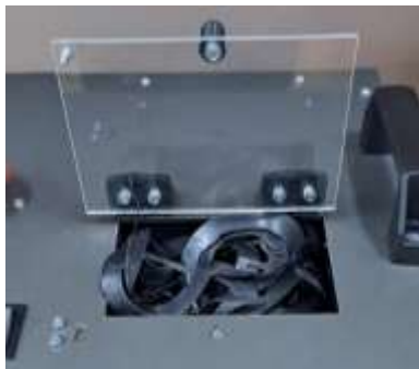
Рисунок 4.2 – Завантажувальний бункер з полімерними відходами
