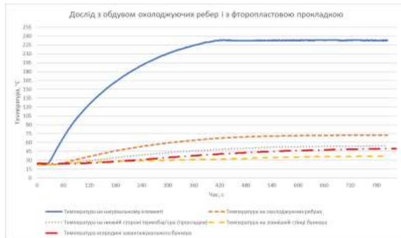
Рисунок 3.35 – Графіки зміни температури від часу в різних місцях шнекового екструдера з обдувом охолоджуючих ребер та обдувом полімеру в завантажувальному бункері і наявністю термобар'єру (фторопластової прокладки)
