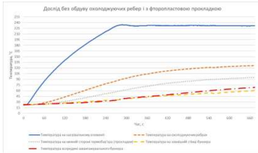
Рисунок 3.33 – Графіки зміни температури від часу в різних місцях шнекового екструдера без обдуву охолоджуючих ребер, але з обдувом полімеру в завантажувальному бункері та наявністю термобар'єру (фторопластової прокладки)
