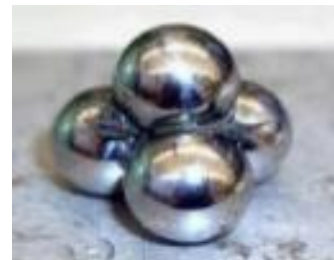
Рис. 2.18. Принципова схема контактної зони та дослідні 4 сталеві кульки.
