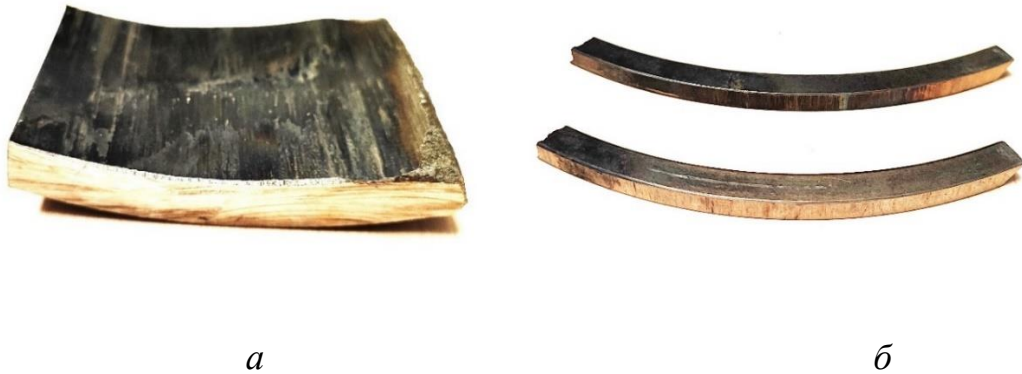
Рис. 7.4 а, б. Фрагменти досліджуваних поверхонь внутрішньої стінки гільзи циліндру (а) та верхнього компресійного кільця (б) ШПГ двигун-генератора ДВГ1А-500.
