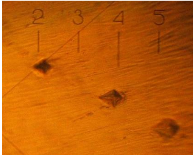
Рис. 2.28. Відбитки пірамідки щодо визначення лінійного зносу методом штучних баз.
