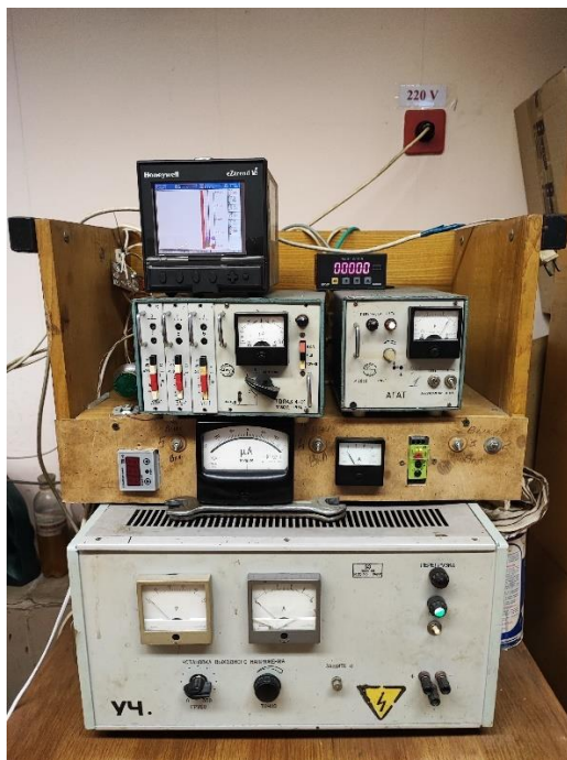
Рис. 2.24. Аналого-цифровий перетворювач (АЦП) «eZtrend V5 Honeywell» та інтерфейс первинних параметрів на АЦП та вихідних на ПК значень (частоти обертання валу).
