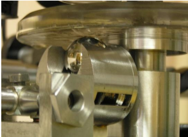
Рис. 2.3 a, б . Контактуюча трибопара індентору і контртіла в точковому контакті: a – коловий контакт ( \beta = 1 ); б – еліптичний контакт ( \beta = 8 ).
