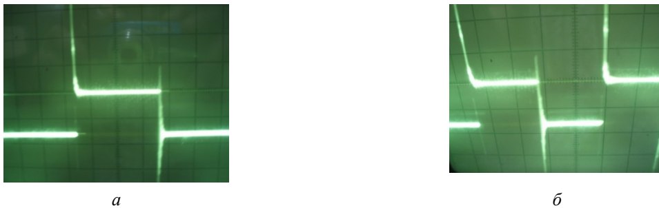
Рис. 2.11 – Осцилограми напруги катодного падіння азотованих з циклічно-комутованим живленням зразків із сталі 38Х2МЮА частотою 1кГц, 50 В/под.
