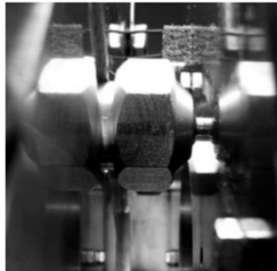
Рис. 2.16 – Взаємне розміщення зразка і контртіла при їх контактуванні
