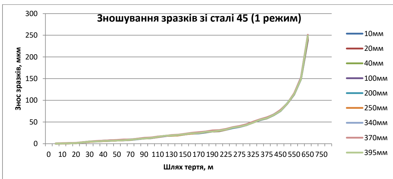
Рис. В22 – Зносостійкість зразків із сталі 45 залежно від висоти їх розміщення від торця труби при азотуванні в ЦКР
