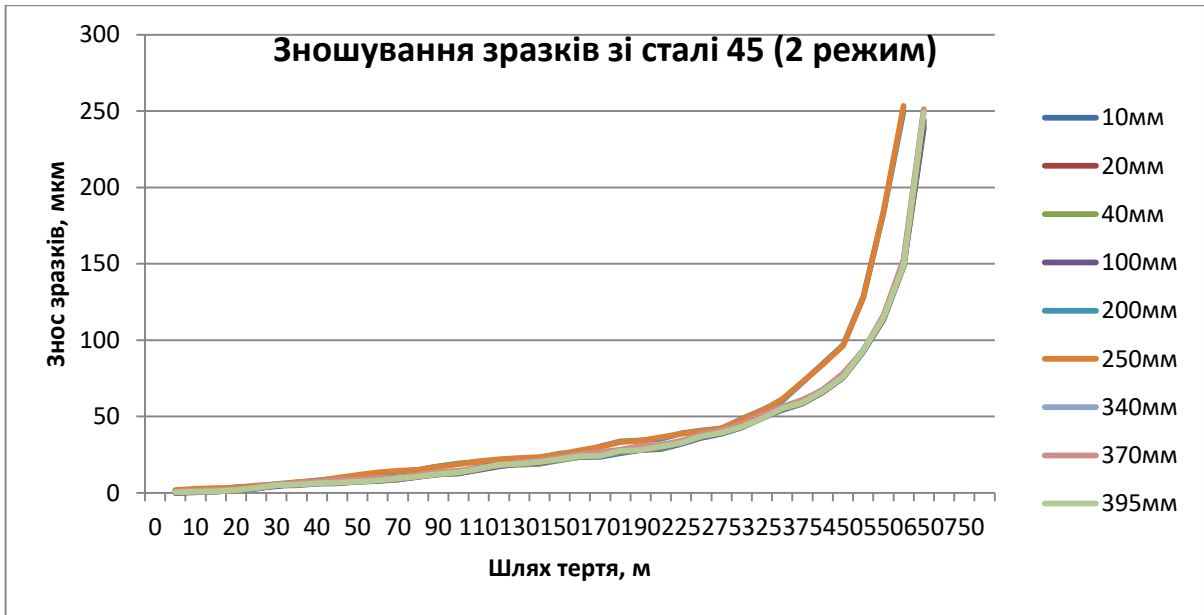
Рис. В23 – Зносостійкість зразків із сталі 45 залежно від їх розміщення від торця труби при азотуванні з постійним живленням
