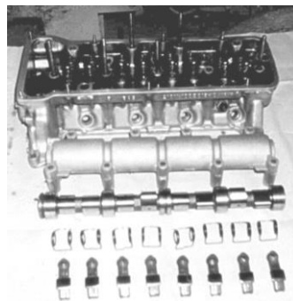
Рисунок 5.13 – Основні деталі газорозподільного механізму
