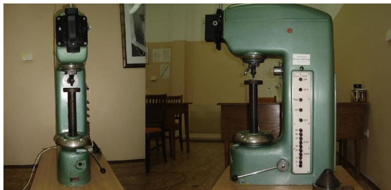
Рисунок 2.8 – Пристрій напівавтоматичного твердоміру Брінелля
