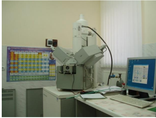
Рисунок 2.10 – Пристрій растрового електронного мікроскопу REMMA-102
