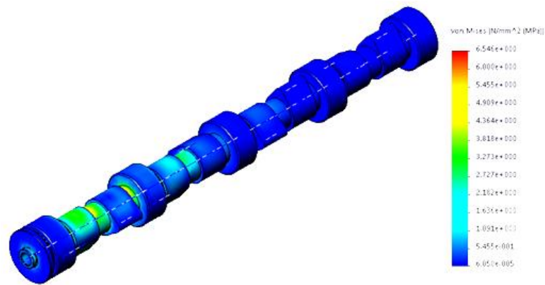
Рисунок 5.6 – Напруження в розподільному валу
