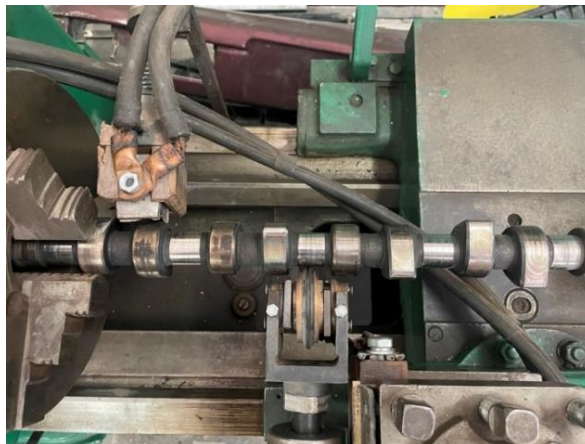
Рисунок 5.17 – Зміцнююча обробка розподільчих валів
