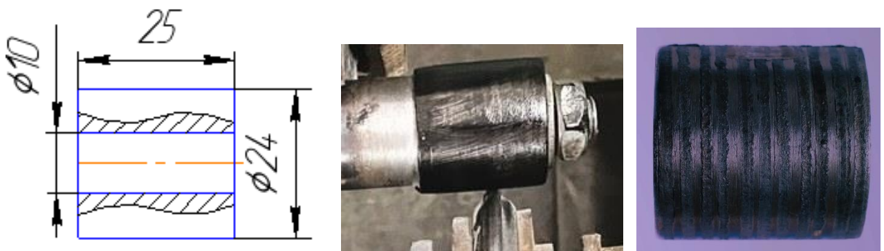
Рисунок 3.5 – Циліндричні зразки для обробки ДОЗ
