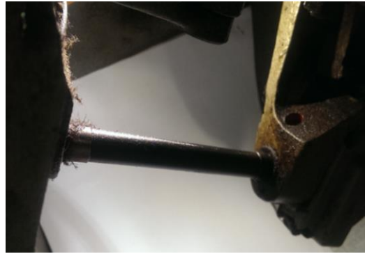
Рис. 1.15 – Вигляд забруднення валу швейної машини 26 А 79916 82кл.
