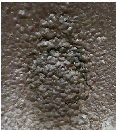
Рис. 4.21 – Фотографія поверхні зразка з модельним забрудненням після оброблення пульсуючим струменем рідини металевими кульками, кут 125^{\circ}
