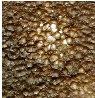
Рис. 4.20 – Фотографія поверхні зразка з модельним забрудненням після оброблення пульсуючим струменем рідини металевими кульками, кут 90^{\circ}
