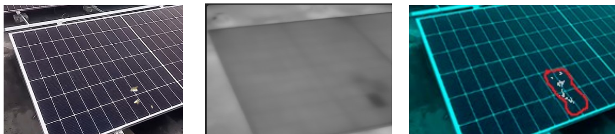
Рисунок 3.5 – Результат злиття термографічних та RGB зображень із заміною R каналу на червоні контури дефектів термограм
