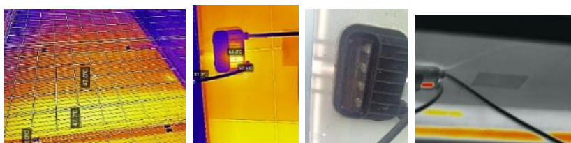
Рисунок 3.7 – Зображення рівномірно нагрітого рядка і коробки з байпасними діодами, зроблене телефоном DOOGEE V20Pro на IR та RGB камеру і тепловізором MPM-625
