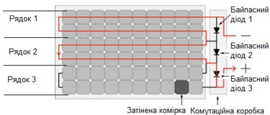
Рисунок 1.3 – Підключення байпасних (шунтуючих) діодів до фотоелектричного модуля
