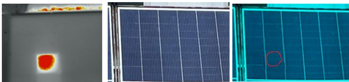
Рисунок 3.14. Зображення з IR, RGB камер та з виходу програмного модуля на базі моделі згорткової нейронної мережі YOLOv12m-seg
