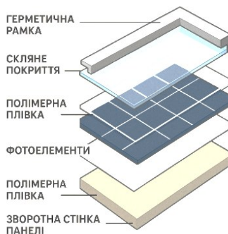
Рисунок 1.2 – Будова фотоелектричного модуля
