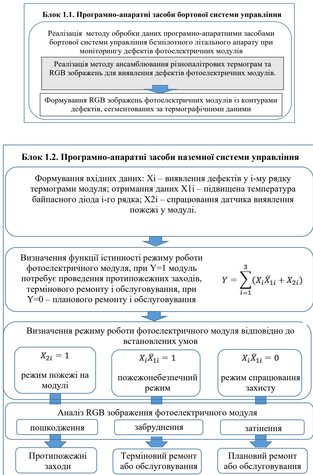
Рисунок 3.9 – Функціонування програмно-апаратних засобів БПЛА
