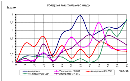
Рис. 17. Динаміка формування товщини мастильного шару h від тривалості випробувань t впродовж прогрівання до T = 363K ( \sigma_{max} = 68 МПа) при швидкості зсуву \gamma = 4 \cdot 10^6 с -1 для зразків: 1 – Ультрагаз; 2 – Ультрагаз + 1% СФС; 3 – Ультрагаз + 2% СФС; 4 – Ультрагаз + 3% СФС; 5 – Ультрагаз + 5% СФС.
