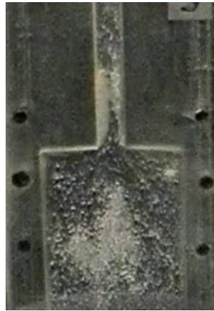
Рис.3.12 – Фотографія прозорого каналу з рідиною в момент початку виштовхування рідини з камери пульсації: виникнення кавітаційної каверни та кавітаційних пухирців, що ще не сплеснулися при частоті коливань 10 Гц
