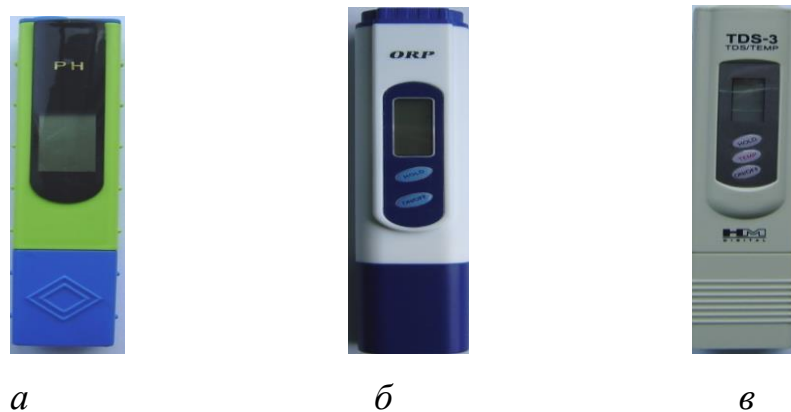
Рис. 2.10 – Загальний вигляд вимірювальних приладів: a – рН Meter; б – ORP TESTER; в – TDS-3
