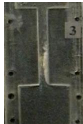
Рис.3.14 – Фотографія прозорого каналу з рідиною, що коливається, в момент виштовхування рідини з камери пульсації: зростання кавітаційної каверни та сплескування кавітаційних пухирців при збільшенні частоти коливань до 10 Гц
