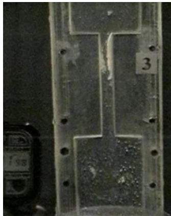
Рис.3.8 – Фотографія прозорого каналу з рідиною, що коливається в момент втягування рідини у камеру пульсації: виникнення кавітаційної каверни та кавітаційних пухирців при частоті коливань 5 Гц
