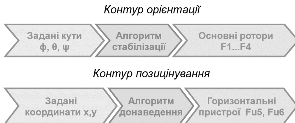
Рисунок 2.4 – Концептуальна схема декупеляції (розв’язки) каналів керування
