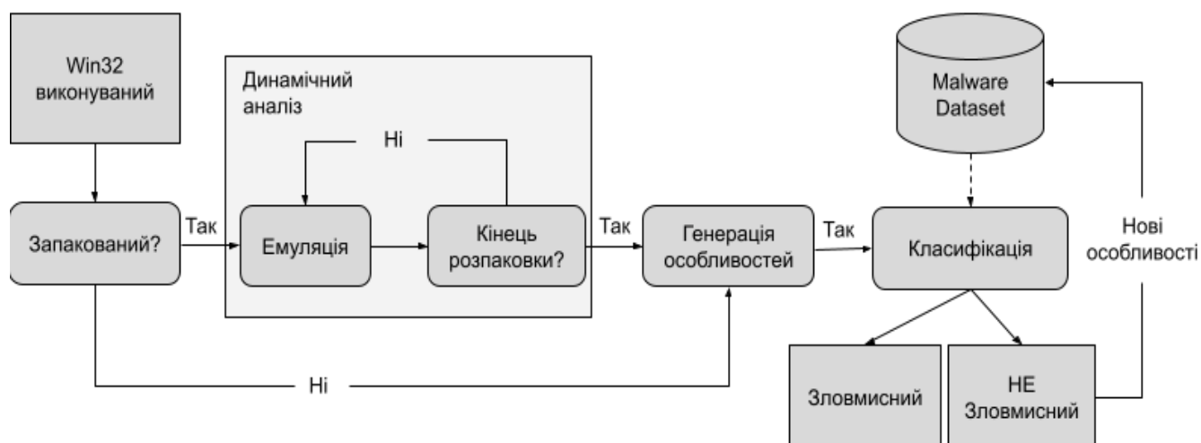
Рисунок 1.3 - Блок-схема системи класифікації ЗПЗ [22]
